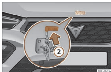
Fig. 192 Palanca bajo el capó.
