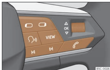
Fig. 8 Lado derecho del volante multifunción: teclas para utilizar los menús y las indicaciones informativas del cuadro de instrumentos (según versiones).
