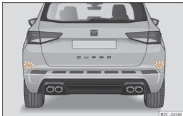
Fig. 104 Vista trasera del vehículo: zonas de los sensores de radar.
