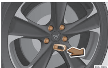
Fig. 207 Rueda: tornillos de la rueda con capuchones.
