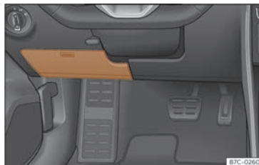
Fig. 187 En el tablero de instrumentos del lado del conductor: tapa de la caja de fusibles.
