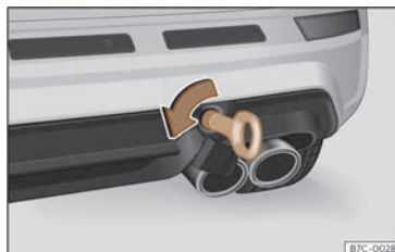
Fig. 186 En el lado derecho del paragolpes trasero: argolla de remolque enroscada.
