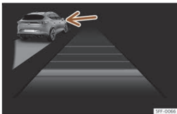
Fig. 111 En la pantalla del cuadro de instrumentos: ACC activo, vehículo detectado por la izquierda.
