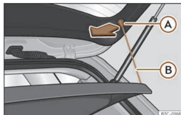
Fig. 157 En el maletero: desmontar y montar la bandeja.
