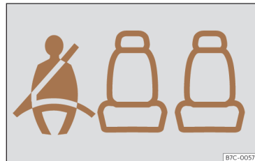
Fig. 16 Cuadro de instrumentos: indicación del estado de los cinturones de seguridad de las plazas traseras.
