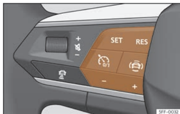
Fig. 107 En el volante multifunción: botones para manejar el regulador de velocidad.
