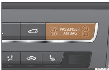
Fig. 26 Tablero de instrumentos: testigo de control de la desactivación del airbag del acompañante.
