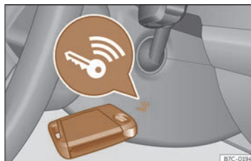
Fig. 90 A la derecha de la columna de dirección: arranque de emergencia.
