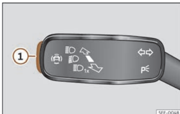
Fig. 99 En la palanca de intermitentes y de luz de carretera: tecla para los sistemas de asistencia al conductor (según versiones).
