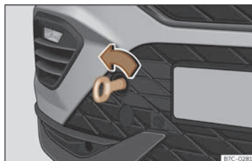
Fig. 184 Part dreta del para-xocs davanter: argolla de remolc enroscada.
