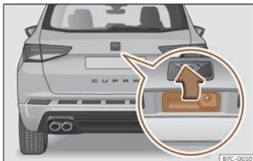
Fig. 54 Porta posterior: obertura des de fora.
