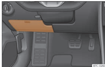
Fig. 187 Al tauler d'instruments del costat del conductor (volant a l'esquerra): tapa de la capsa de fusibles.
