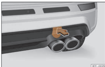
Fig. 185 A la part dreta del para-xocs del darrere: retirar la tapa.
