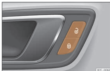
Fig. 49 A la porta del conductor: commutador del tancament centralitzat.
