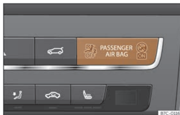
Fig. 26 Tauler d'instruments: indicador de control de la desactivació del coixí de seguretat de l'acompanyant.
