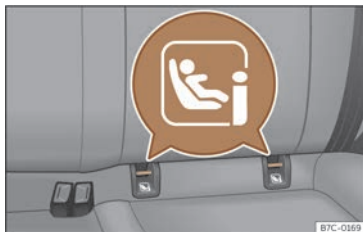
Fig. 35 Seient del darrere: ubicació de les anelles de subjecció ISOFIX o i-Size.
