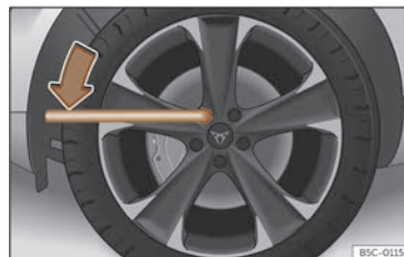
Fig. 209 Canvi de roda: afluixar els caragols de roda.
