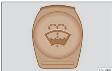
Fig. 196 Al compartiment del motor: tap de color blau del dipòsit de l'eixugavidres.
