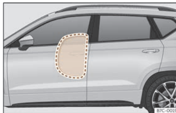
Fig. 28 Coixí de seguretat lateral completament inflat al costat esquerre del vehicle.
