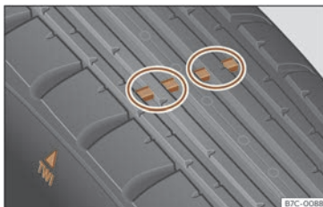
Fig. 203 Perfil del pneumàtic: indicadors de desgast.
