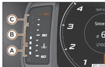
Fig. 4 Indicador de temperatura del líquid refrigerant del motor.
