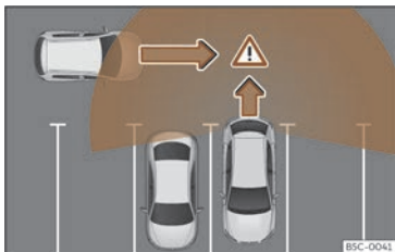
Fig. 143 Representació esquemàtica de l'assistent de sortida de l'aparcament: zona vigilada al voltant del vehicle que està sortint de l'aparcament.
