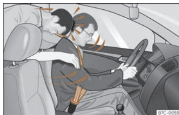
Fig. 18 L'ocupant del seient del darrere que no porti el cinturó de seguretat es veurà projectat cap endavant sobre el conductor que sí que porta el cinturó.
